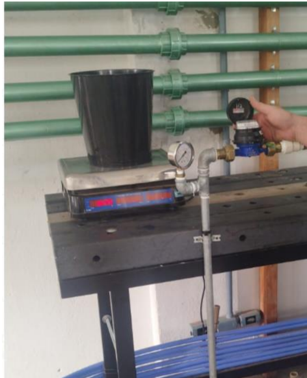
Figura 3 - Detalhe da bancada de testes onde se verifica o hidrômetro e medidor de pressão instalados no cavalete de teste.
